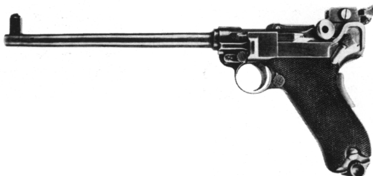
Parabellum Mod.1900 SCHWEIZ, abgeändert zur einschüssigen Pistole im Kaliber .22 lfb Die Laufbohrungsachse liegt unter dem Mittelpunkt des Hülsengewindes. Dieser Prototyp benützt den originalen Schlagbolzen, der Auszieher wurde geändert. (aus „Luger Variations“ von Harry E. Jones)
