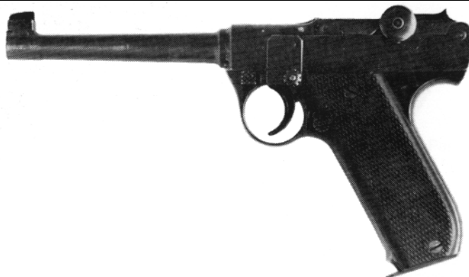
Prototyp einer Selbstladepistole im Kaliber .22 lfb mit Kniegelenkverschluß. Arbeit eines unbekanntes schweizerischen Büchsenmachers.
