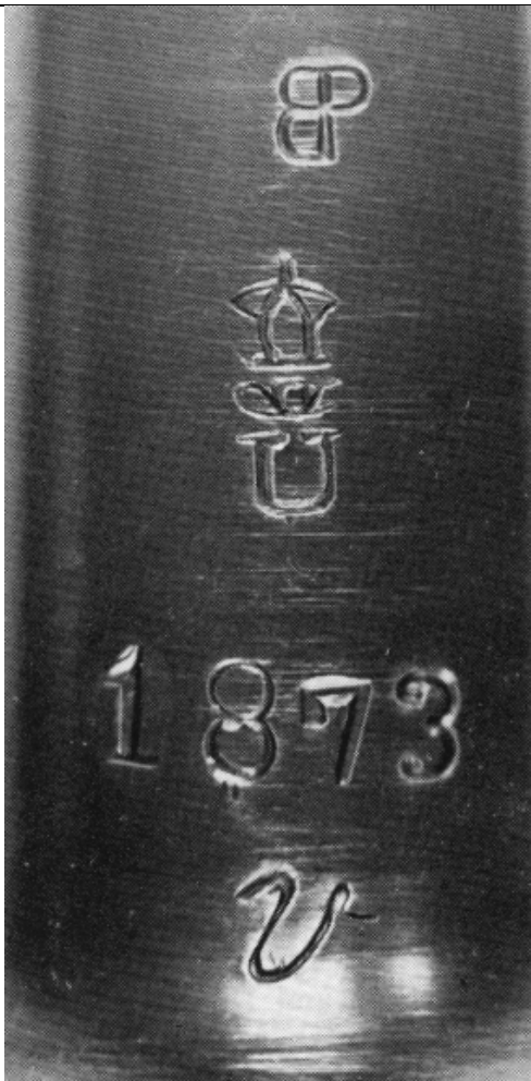
Inspektionszeichen Nr. 5 Beschußzeichen Nr. 9 Seriennummer (Mod.06/34 Mauser Commercial)
